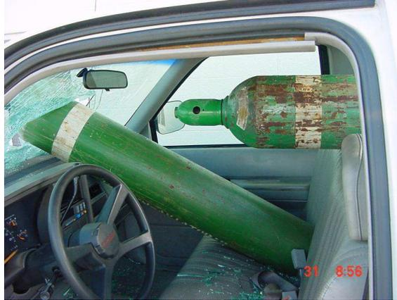
Algunos gases como el Propano, el Dióxido de Carbono (CO<sub>2</sub>) y el Acetileno no deberían transportarse tumbados ya que el gas de estas botellas está **licuado**, o como en el caso del Acetileno, **disuelto** en acetona. Por consiguiente, existe un gran riesgo de que se produzca un escape por la rosca de la válvula y de que el gas se acumule en cantidades suficientes para formar una mezcla explosiva o asfixiante dentro del vehículo.
